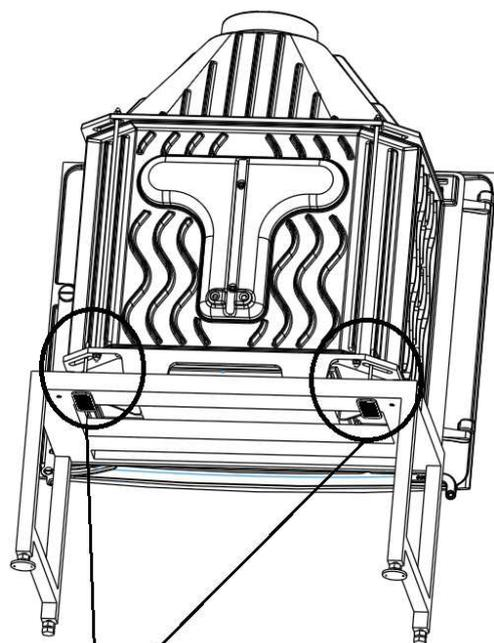
Réaliser la fixation de l'appareil à l'aide des deux pattes + écrous fournis avec l'appareil
